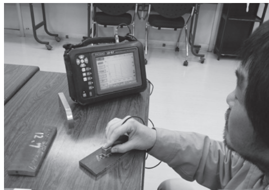
写真1 白土技師が探触子を試験体に当て超音波装置のディスプレイを見ているところ
