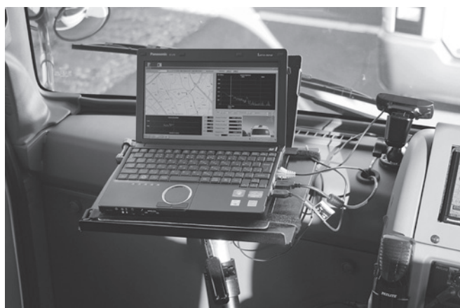
写真1 車内に設置されたラジプローブのモニター部
