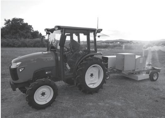
写真一③ 放射線測定車両(FMV)
