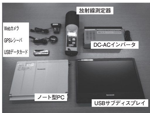
図2 車載部構成機器
