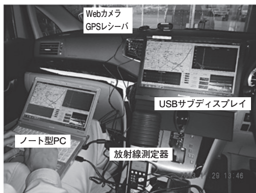
図3 車載部運用例
