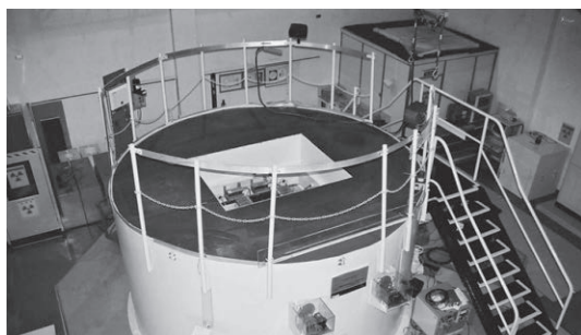
図2 近畿大炉(UTR-KINKI) (直径約4m×高さ約2m)
