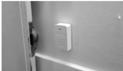
写真5 ガラス線量計システム(上)と環境放射線測定用ガラスバッジ(下)
