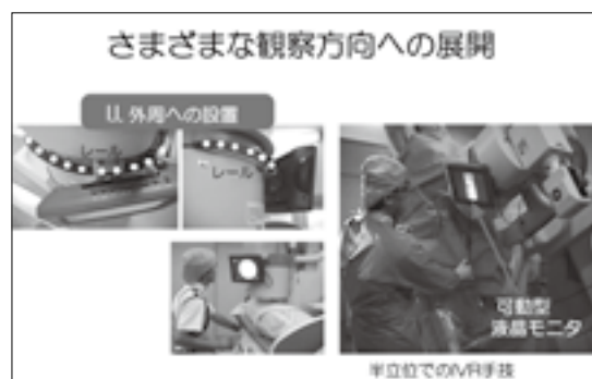
Fig. 5 小型LCDのI.I.側面への装備仕様 IVR医はI.I.周囲を取り巻くように立つ。そのためI.I.側面にレールを敷設させて周囲を移動できる仕様。
