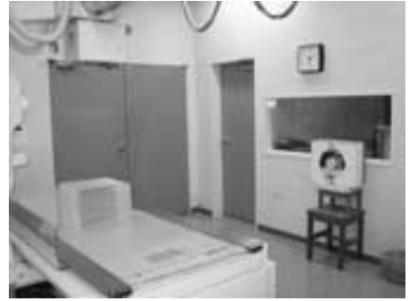
Fig.2 低線量率長期間測定の幾何学的配置図 (X線透視)
