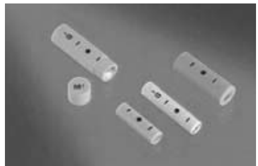
Fig 2 ガラス線量計ホルダ
