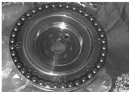
図4 グラファイト化した炭素試料は径1mmの細孔に充填し、数十個単位で、標準や空試料と同時に同条件で測定する。
