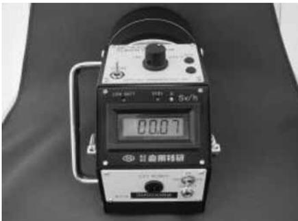
写真2 応用技研製電離箱サーベイ AE-233
