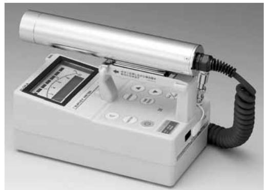
写真1 アロカ製シンチサーベイ TCS-171
