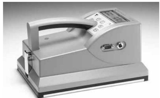
写真4 Berthold製 $\alpha/\beta$ サーベイ LB124 SCINT
