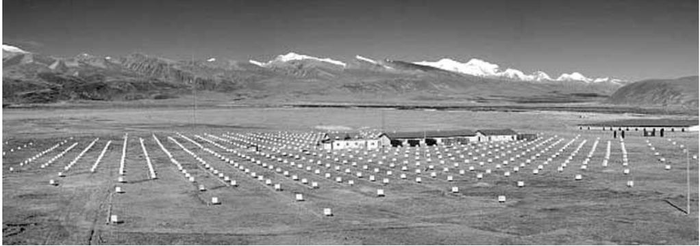
図2：中国チベットの標高4300メートルの高原に設置された宇宙線観測装置。約 $10^{16}$ から $10^{17}$ 電子ボルトの宇宙線の研究でいろいろな成果を出している。図中白色の箱のようなものが空気シャワー粒子の測定装置で、シンチレータと光電子増倍管からなっている。(東京大学宇宙線研究所提供)
