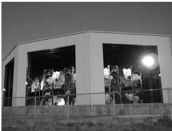
図3：最高エネルギー宇宙線を観測する装置の一部。一つの建物の中に多くの望遠鏡が設置してあり、数十 km 先の大気まで観測する。これと同様の建物が合計3箇所あり、一つの空気シャワー発光現象を最大3カ所で別方向から監視できる。それとともに、3台の望遠鏡ステーションで囲まれたところには地表に検出器が1.2km おきに設置してあり、地表に到達した空気シャワーを観測する。(東京大学宇宙線研究所提供)
