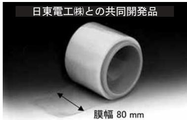
図5 開発した高分子電解質膜
