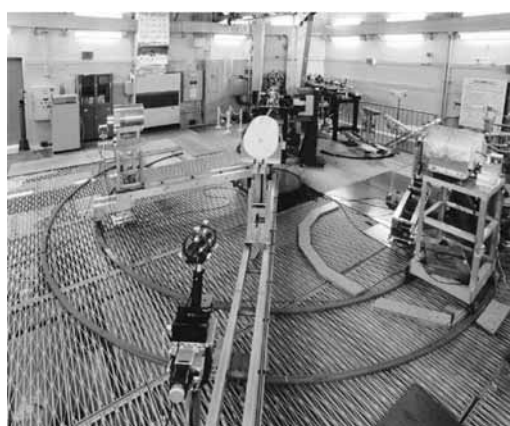
図 1：独産業技術総合研究所 計量標準総合センターの単色中性子フルエンス国家標準場
