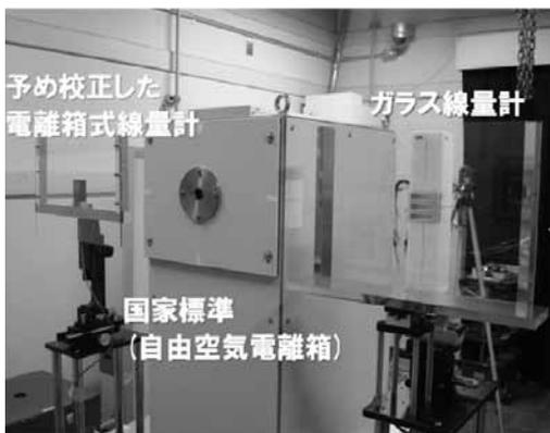
図2 産総研におけるガラス線量計の特性評価の様子
