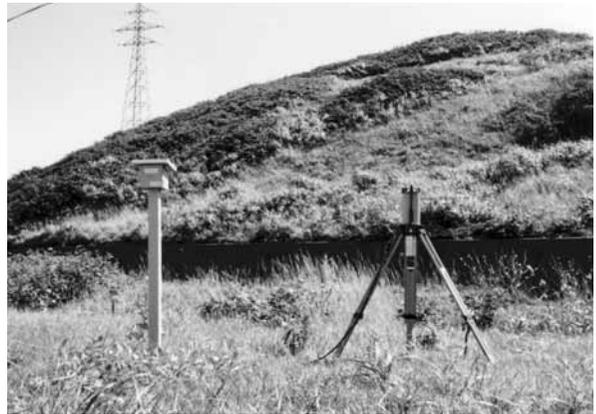
図3 ガラス線量計設置箱 (左) と in-situ Ge 半導体検出器 (右)
