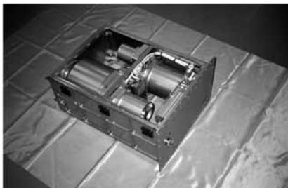
図8 JAXA が製作したボナーボールの写真
