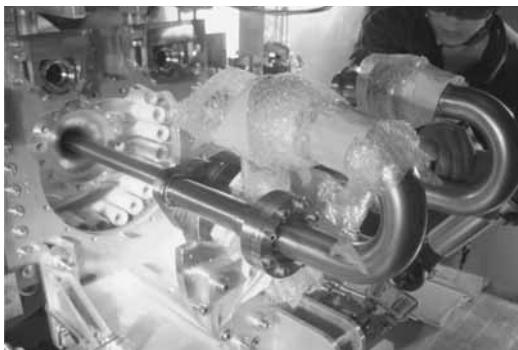
図4：フルリモート操作で組み込み試験中のターゲットと電磁レンズ。そばに立っている人は操作の監視をしている。
