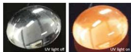
図1 Li含有蛍光ガラス線量計から生じるRPLの様子
