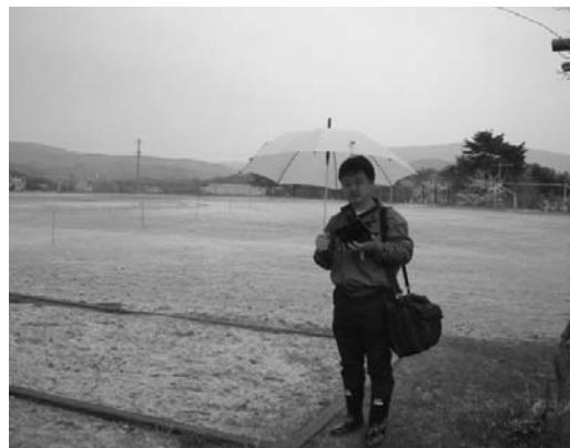
写真1 GPS機能を付加したNaIサーベイメータによる歩行サーベイ
