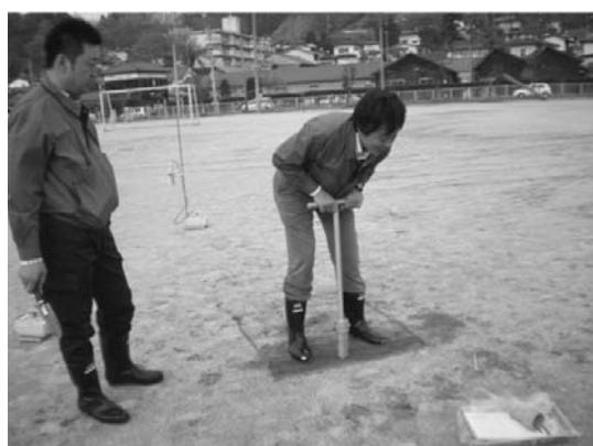
写真2 土壤採取器によるサンプリング風景
