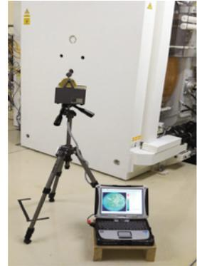
図3 ガンマ・キャッチャーによる測定風景
