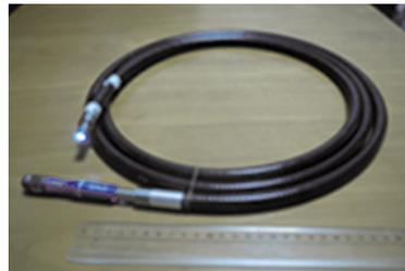
図1 LSLGチューブ(長さ : 3 m、内部チューブの直径 : 8 mm)。チューブの先端を光電子増倍管のヘッドに接続すれば放射線検出器になる。LED(波長λ=375nm、1 mW)を照射すると波長λ=420-450nmの発光が見られる。
