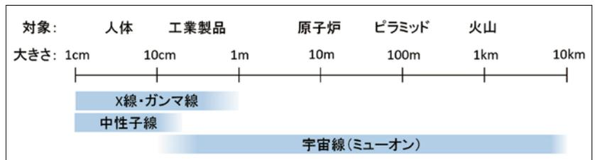
図1 放射線イメージングに用いる粒子種とそれらが対象とする物体の一例およびその大きさ
