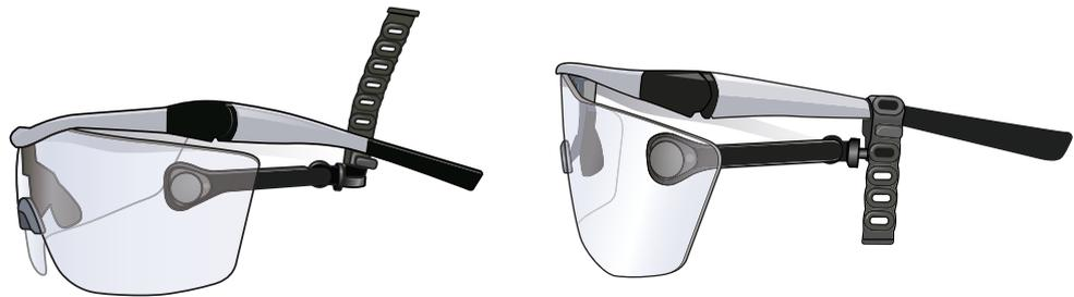
検出部が防護メガネの内側かつ目尻の位置にくるように2軸部分を使って垂直・水平方向に最終調整してください。
