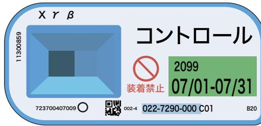
コントロール用線量計は、貴事業所におけるバックグラウンド（自然放射線）の値を差し引くためのものです。人工放射線の影響のない常温常湿の場所に保管してください。コントロール用線量計と測定依頼を受けた線量計を比較し（X線用ガラスバッジを除く）、線量を算定します。測定依頼をされる際は、必ずコントロール用線量計を同封してください。
