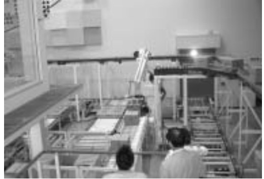
照射カートンを操作するロボット
