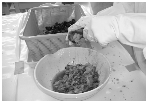
環境試料の前処理 (ムラサキガイの貝殻を除き、軟体部を磁製皿に移す作業)
