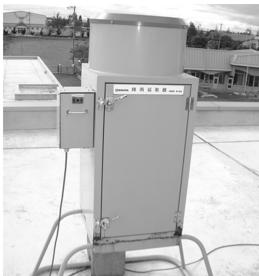
降雨採取装置(トリチウムを分析するための雨水を採取)
