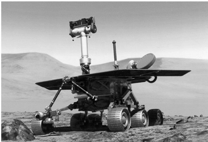
図8 火星探査に用いられている無人遠隔操作計測車ローバー
