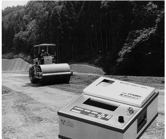
図2 土締固め度を計測する水分・密度計
