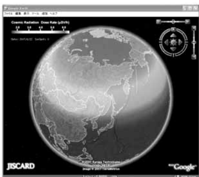
図6 JISCARDの拡張データとして提供している航空機の巡航高度(11km)における宇宙線強度のグローバル分布画像(Google Earth形式);太陽黒点数の観測データに基づいて日々計算・更新している( http://www.nirs.go.jp/jiscard/data/option_drmap.shtml )
