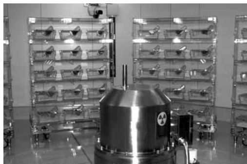
図5 ガンマ線連続照射室(線源は 137 Cs)中央が照射装置(照射時は装置上部の突起部分に線源が上昇)線源を取り囲みポリカーボネイト製動物照射用棚を配置
