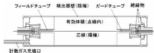
図1 円筒型比例計数管の構造
