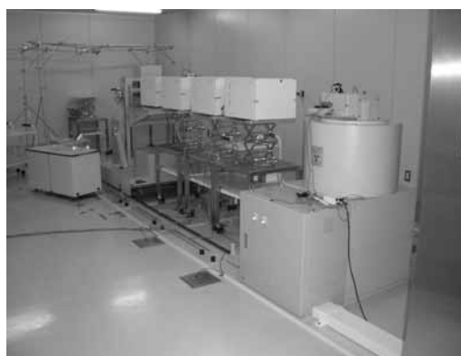
図6 ガンマシミュレータ室内部手前が照射装置(線源格納容器)、その奥が細胞照射用インキュベータが3台、さらにその奥にインキュベータを乗せた移動台車が置かれている。放射線は格納器上部のコリメータ部から移動台車側に向けて照射される。
