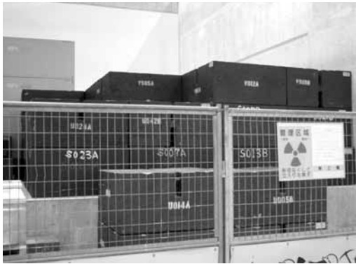
写真2 Energy Solutions社製リサイクル鉄ブロック、地元自治体への説明に使い管理区域内に設置している (加藤洋二氏(高エネ研)撮影)
