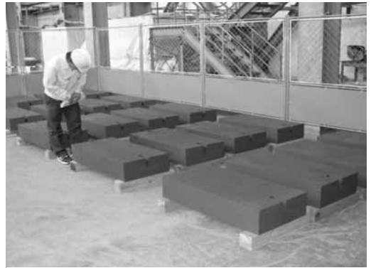
写真 1 日本原子力発電所からのクリアランス鉄材で作製した鉄ブロック (加藤洋二氏(高エネ研)撮影)
