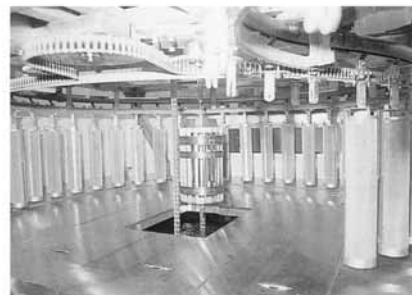
沖縄のウリミバエ不妊化施設 コバルト60でガンマ線を照射する装置
