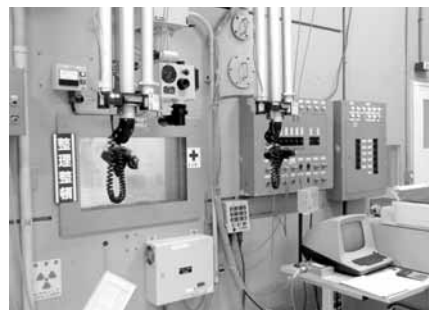
写真－3 重量コンクリートケーブ
