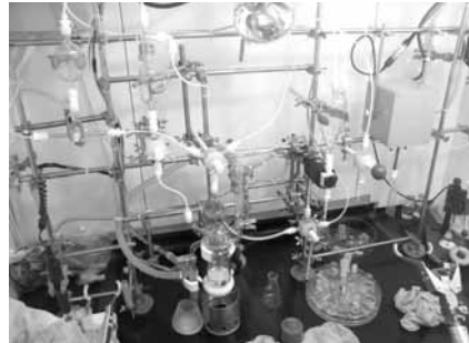
写真-4 Re-186 製造装置
