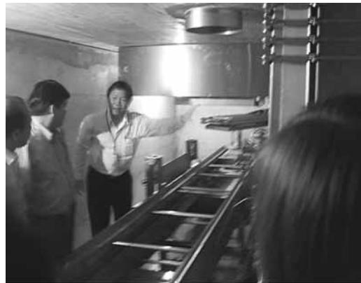
カナダから輸入した10-20MeV・10kWの電子加速器(宝石の照射専用に使用)のビーム取り出し部分
