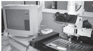
図44 エッチピット自動計測装置
