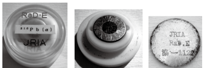
a) 標準線源とその容器 b) 茶色の線源面見える状態 c) 線源の裏面 注：裏面に線源名と番号の刻印があり、添付書で検定の放射能値が分かる。中央円焦げ茶色の線源面を傷つけない用具で慎重な取扱が肝心。
