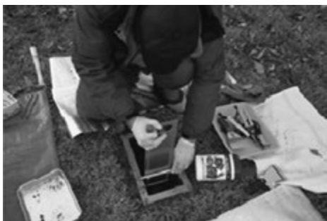
図4 スクレーパープレートによる深度別土壌試料採取の様子
