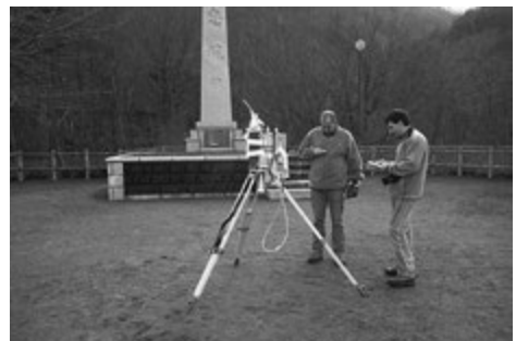
図2 可搬型Ge検出器を用いた in situ 測定の様子
