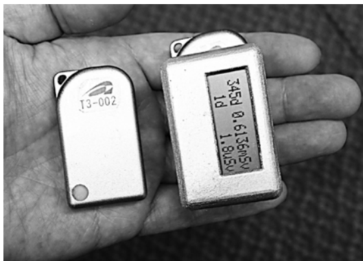
図1 (国研)産業技術総合研究所で開発された小型軽量電子式線量計
