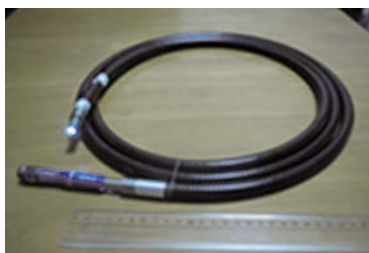
図1 LSLGチューブ(長さ: 3 m、内部チューブの直径: 8 mm)。チューブの先端を光電子増倍管のヘッドに接続すれば放射線検出器になる。LED(波長 \lambda =375nm、1 mW)を照射すると波長 \lambda =420-450nmの発光が見られる。
