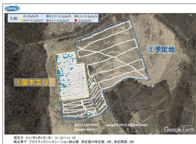
図6 ブドウ畑に係る空間線量率調査結果(地上高さ1m) (JAEA福島環境安全センターの協力による測定)
