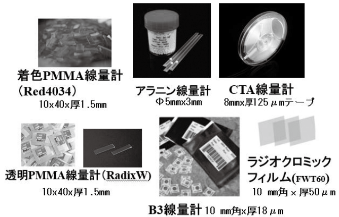
図1 大線量域用線量計素子の例
