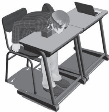
図3 甲状腺モニタによる測定のイメージ図
