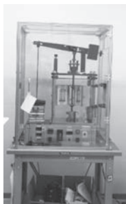
写真7 スモールパンチ クリープ試験機
