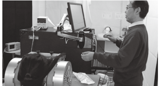
図1 電子スピン共鳴法による線量測定
