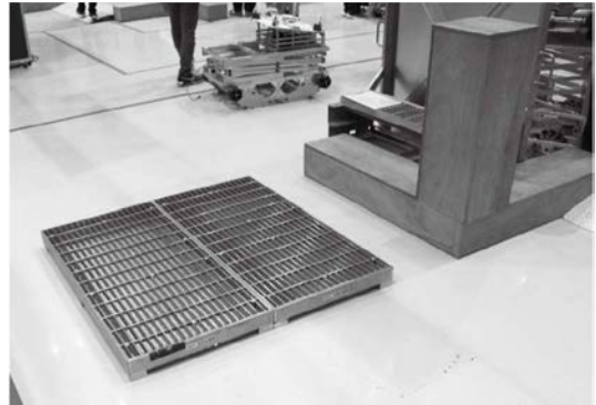
写真6 難所となった高さ95mmのグレーチングと曲がり角
