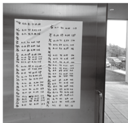
図3 環境バックグラウンド記録表 GM、NaI（TI）サーベイで測定した室内および室外の測定値を毎日記録している
