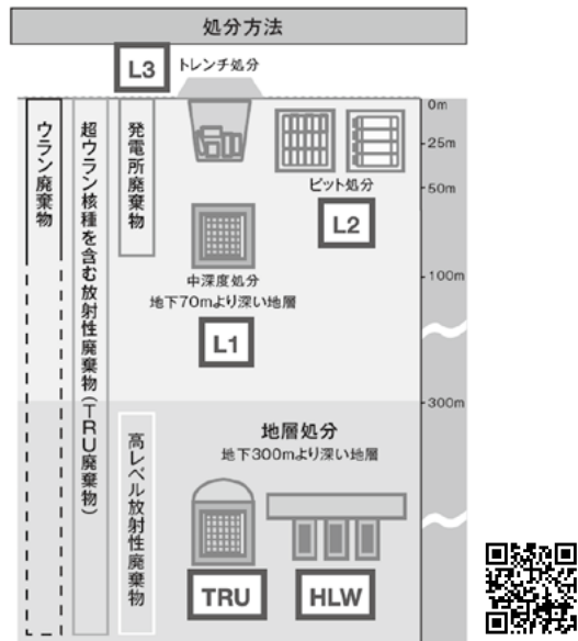
図2 異なる放射性廃棄物の処分の概要 (原子力エネルギー図面集を一部改編： https://www.ene100.jp/zumen/8-1-5 )。
