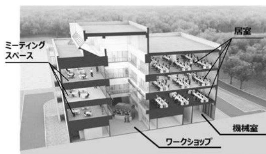
図3 施設管理棟断面
