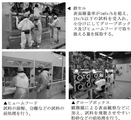
図5 第1棟の主要な設備
