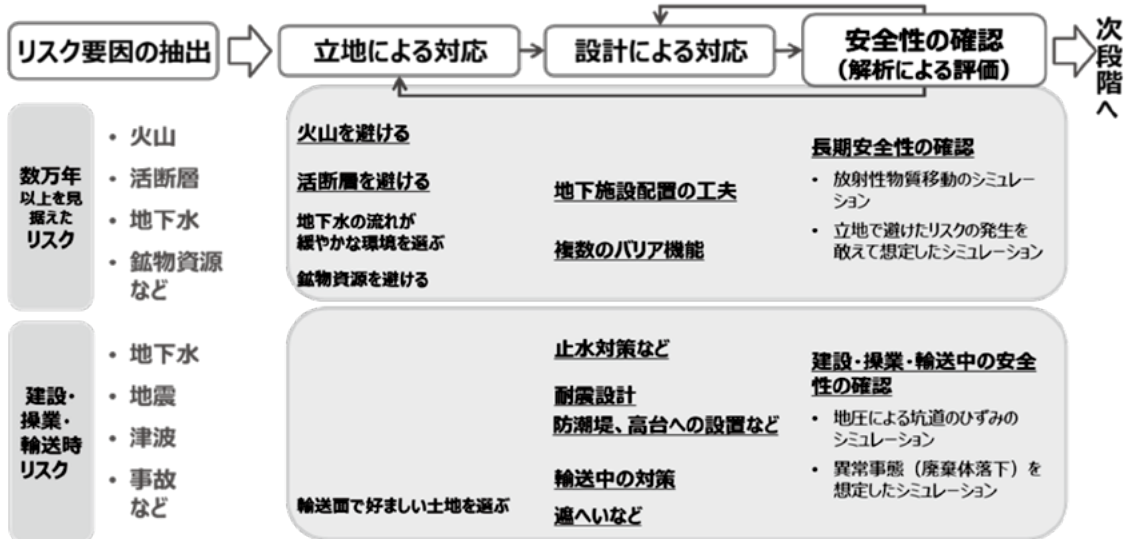
図1 地層処分におけるリスクとその対策の考え方 2)
