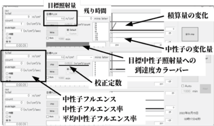
図5 ビームモニタリングの画面。リアルタイムに中性子発生量の変化をグラフで捉えることができる。
