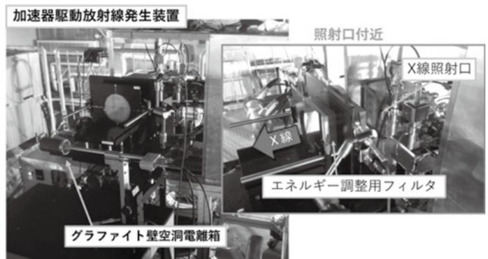
図5 産総研が開発した、小型加速器を用いたCs-137模擬ガンマ線発生装置。(産総研プレスリリースより引用<sup>7)</sup>)
