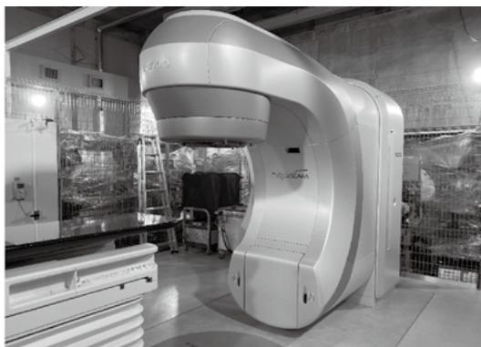
図2 産総研に設置された医療用リニアック装置 (Varian社 VitalBeam)。高エネルギー光子線および高エネルギー電子線を発生することができる。光子線の最大線量率は24 Gy/min、電子線の最大線量率は10 Gy/minである。
