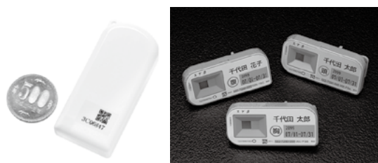
図4-2 ガンマ線量計 (左)D-シャトル (右)RPL線量計(千代田テクノル社製)
