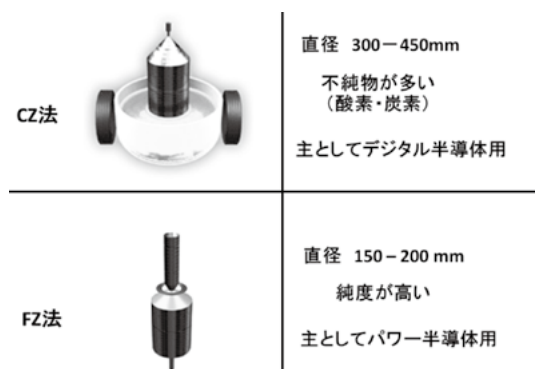
図5 シリコン半導体製造技術の概要
