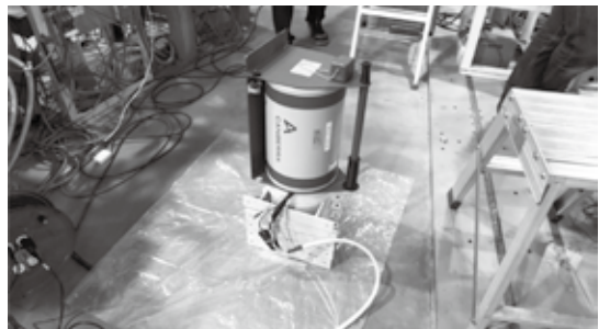
図2 遮蔽体付Ge検出器による床面コンクリートの測定
