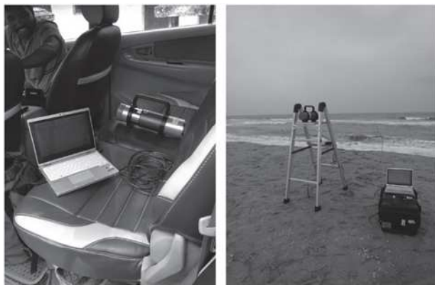
図4 走行サーベイ法と定点測定法
