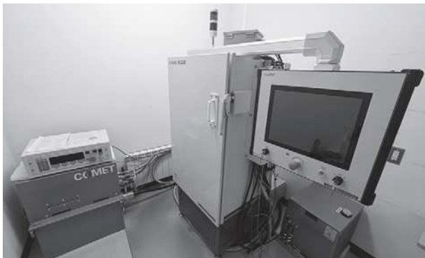
図2 X線発生装置(X-RAD iR-225)
